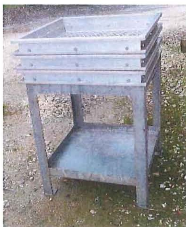
Photo 6 : Table de tri équipée de ses 3 tamis (20, 10 et 5 mm). (Source : F. Bordeyne)
