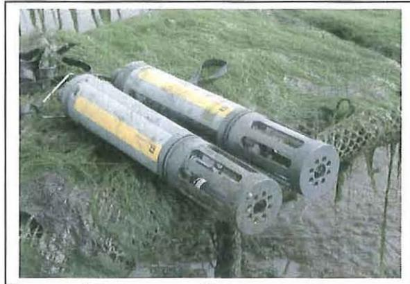
Les deux sondes YSI posées sur les tables à 70 cm du sédiment. Les capteurs se trouvent dans une sorte de bocal protégeant les sondes tout en laissant passer l'eau.
