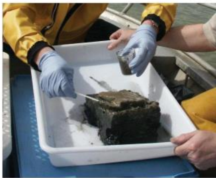
Figure 4 : Prélèvement du premier centimètre superficiel d'une carotte obtenue à l'aide d'une benne de type Ekman sur embarcation légère.
