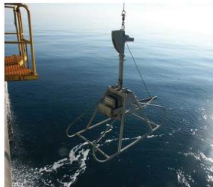
Figure 5 : Mise à l'eau d'un carottier-boîte de type Micro-Reineck sur navire hauturier.
