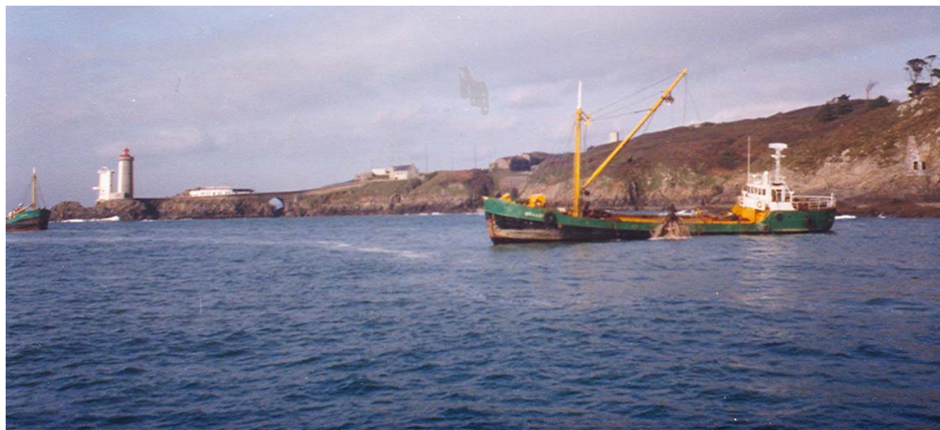
Extraction à point fixe par un navire à benne preneuse sur le site du Minou en Bretagne (© Ifremer)
