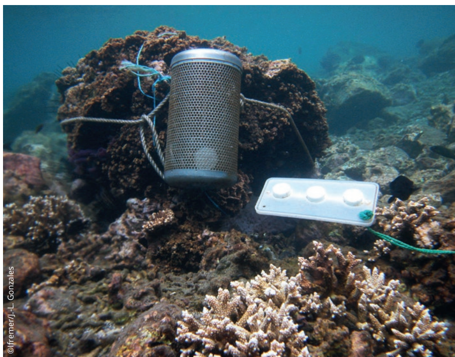
Échantillonneurs passifs POCIS (cage métallique) et DGT (plaque blanche) immergés en milieu lagunaire
