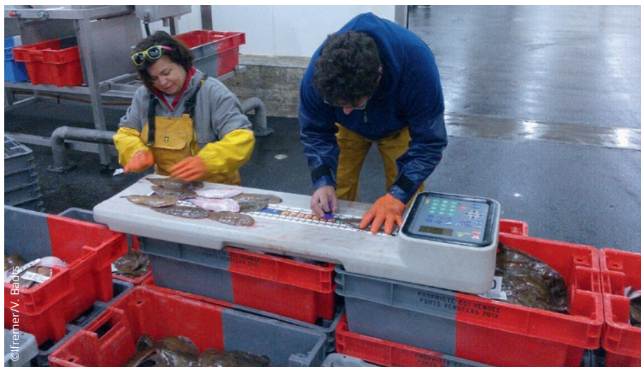
Mesure des tailles de poissons à l'aide de l'ichtyomètre
