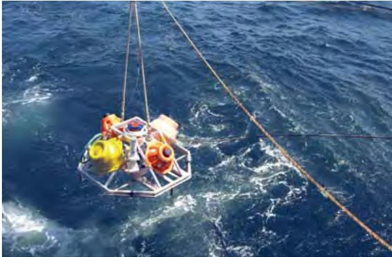
Chassis comportant un profileur acoustique de courant 300 kHz
