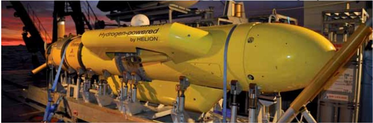
Essai d'une pile à combustible sur l'AUV Idef<sup>6</sup>
