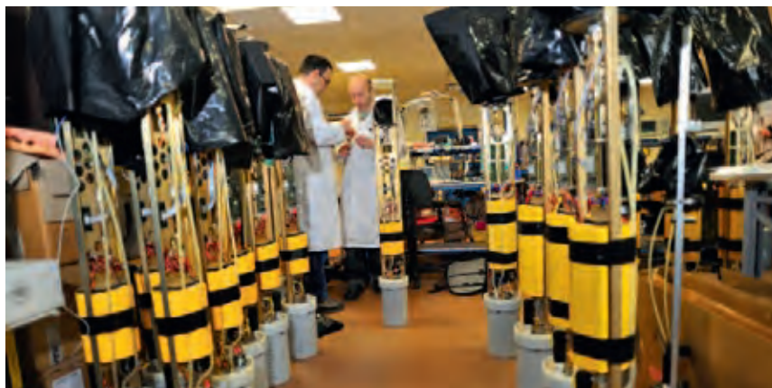
Fabrication des flotteurs (ou profileurs) océaniques Arvor et Provor par la société NKE
