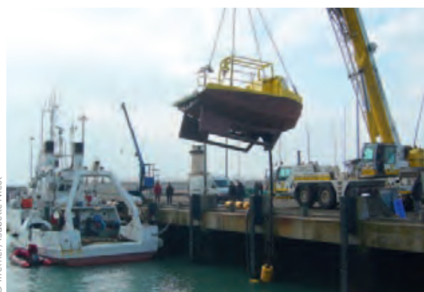
Travaux de maintenance de la bouée Molit lors de l'opération de carénage annuel 2011
