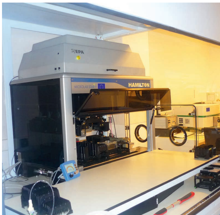
▲ Les éléments de la plateforme de culture et d'isolement haut débit Cocagne (IUEM) : le robot de pipetage, l'enceinte anaérobie et le cytomètre de flux
