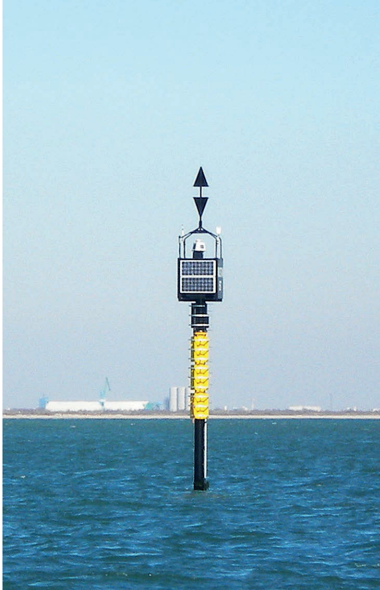
▲ Bouée instrumentée Mesurho, installée à l'embouchure du Rhône
