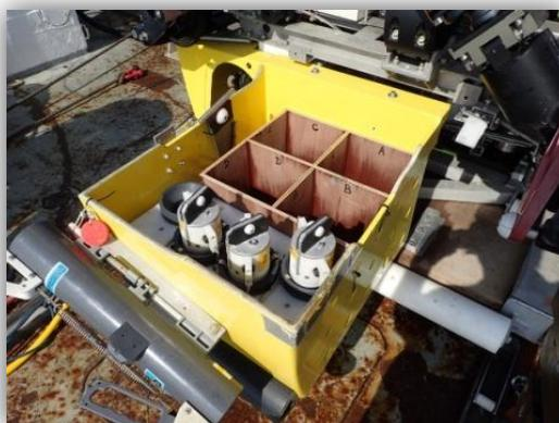
© Ifremer - panier déployé du HROV Ariane contenant un casier de prélèvements à plusieurs compartiments (A, B, C et D), le rack carottier tube et la bouteille NISKIN.
