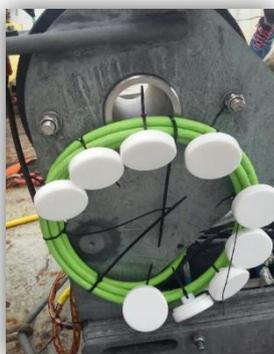
Les chimistes de l'UPPA ont fixé sur le lest du HROV des échantillonneurs passifs « chemcatchers ». Ces dispositifs permettent de capter des micropolluants présents dans le milieu.
