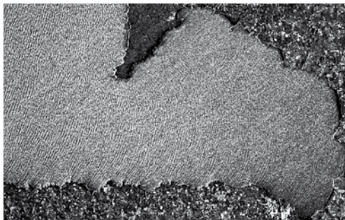
Figure 10 : image du radar SAR du satellite ENVISAT montrant un train de houle entrant en Baie de Douarnenez (Bretagne, France).
