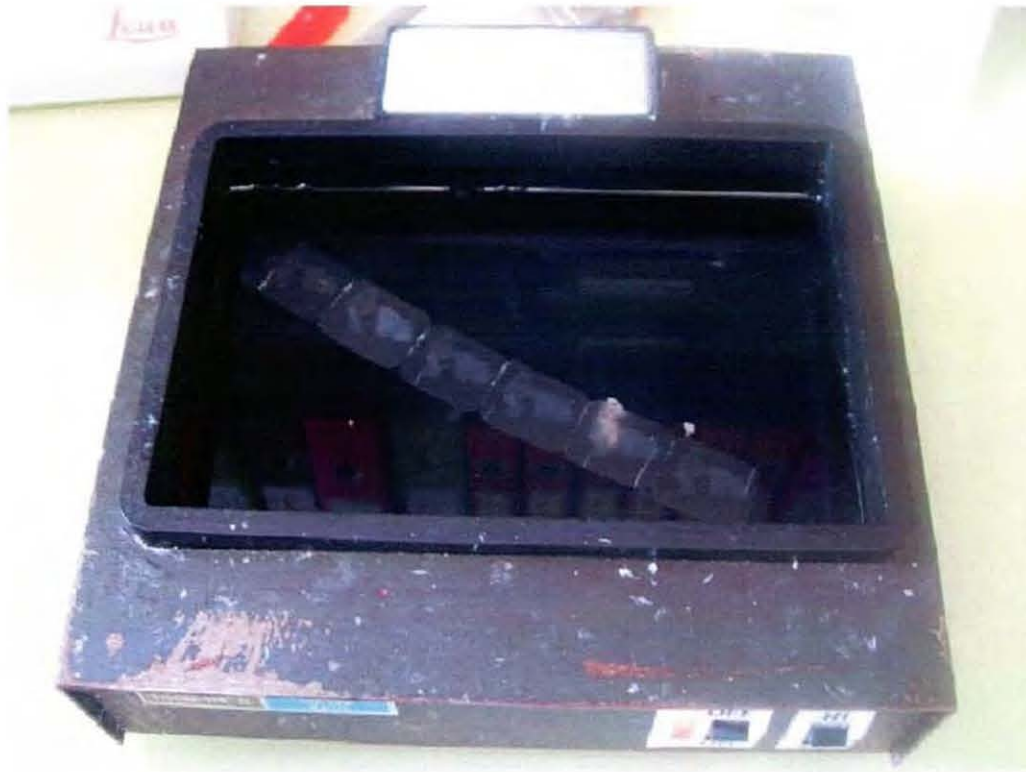
Figure 9. Bain marie d'histologie. On peut voir sur le ruban les coupes des tissus et sélectionner la moins abîmée pour la mettre sur lame.
