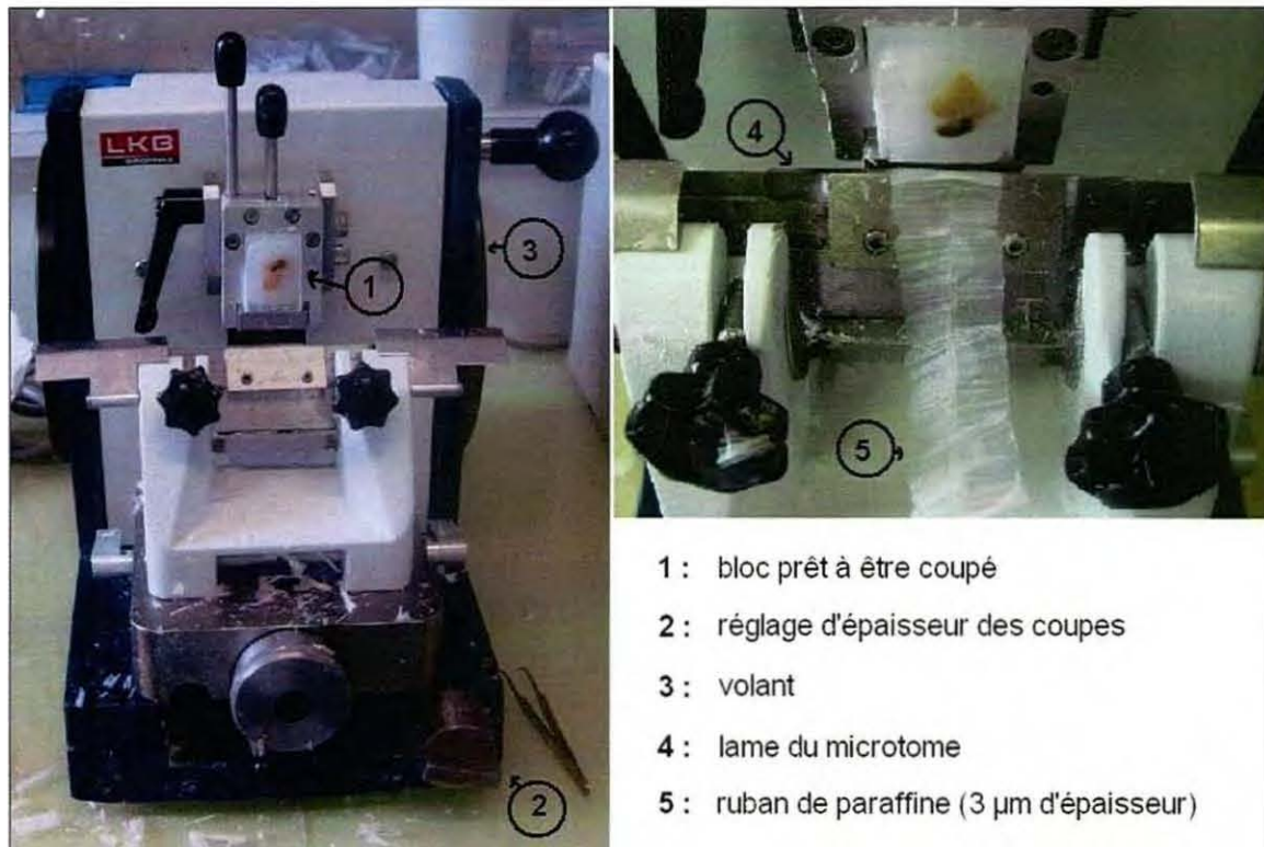
Figure 8. Le microtome permet de réaliser des coupes de différentes épaisseurs.
