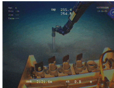
Photo d'un carottage sur le fond avec le Rov
