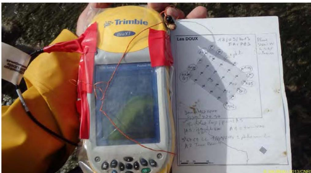
**Figure 5** : Prise de notes associant table attributaire du DGPS et feuille terrain, exemple pour la station les Doux 2013 sur la masse d'eau côtière «FRFC02 - Pertuis charentais». Photo 18/09/2013 P.-G. Sauriau CNRS ©.
