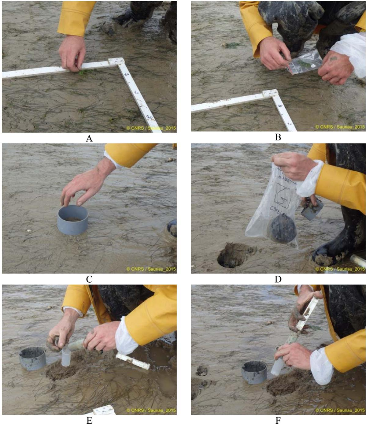
**Figure 4 :** Visualisation des prélèvements de macroalgues (A, B), granulométriques (C, D) et de sédiments pour l'analyse de la matière organique (E, F) illustrant le protocole commun à toutes les stations à herbier de *Zostera noltei*. Photo P.-G. Sauriau CNRS ©.
