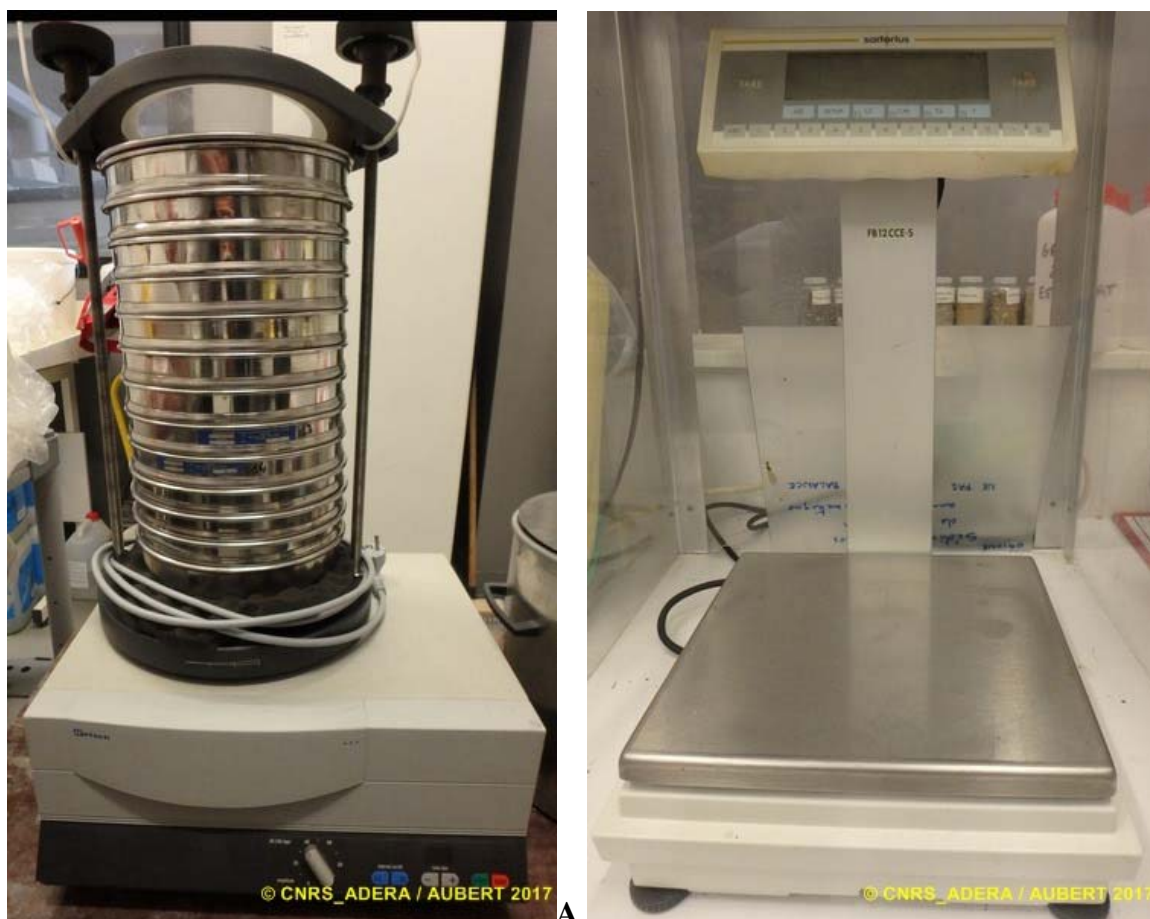
Figure 15 : Colonne de tamis normalisés AFNOR sur tamiseuse Retsch (A) et balance Sartorius à 0,01 g (B). Photo F. Aubert COHABYS ©.
