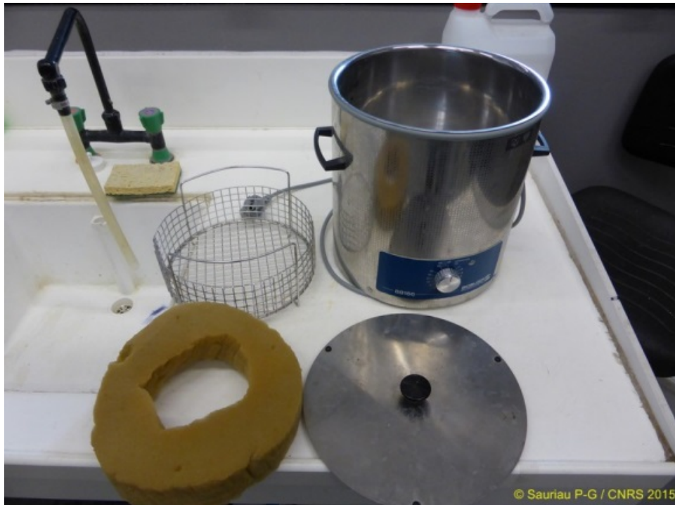
Figure 16 : Bain à ultrasons (A) avec détails du porte tamis et de la collerette en mousse (B) pour maintenir un bol à sédiment. Photo P.-G. Sauriau CNRS ©
