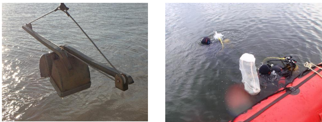
Figure 2 Mise en œuvre de la benne van Veen (gauche) et de la suceuse à air par des plongeurs (droite)
