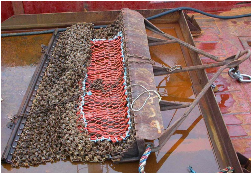
Figure 2 : Engin de prélèvement utilisé : drague de type « New Bedford » de 8 pieds (2.44 m)
