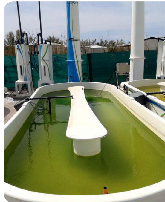
▲ Bassin ouvert de culture d'algues utilisé pour les expérimentations sur la remédiation de fumée d'usines (Plateforme Ifremer Palavas). © Éric Fouilland
