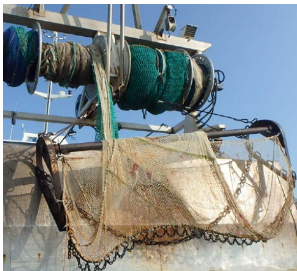
Photo 1 : Chalut perche trois mètres avec bourrelet chaîné et racasseur.
