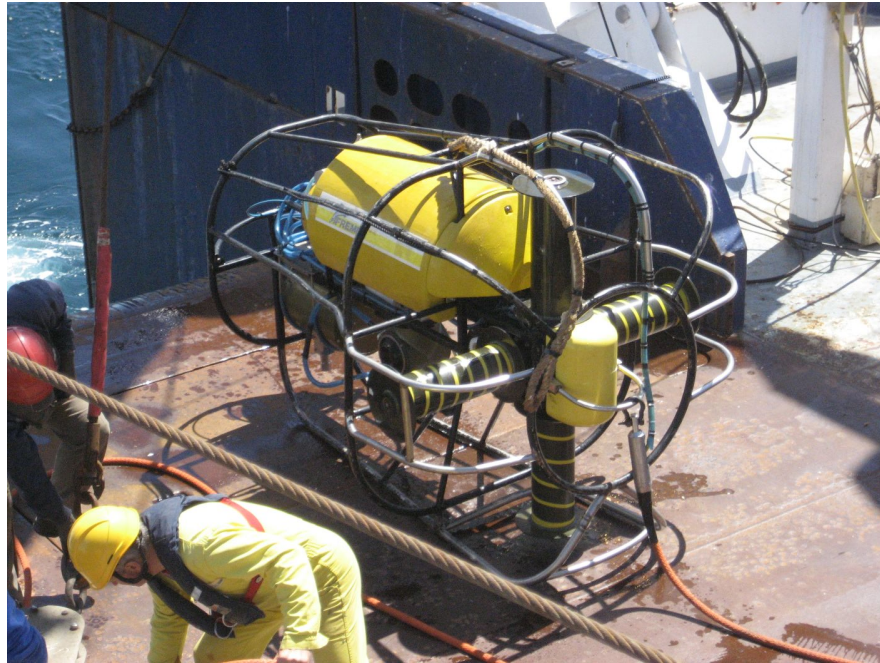
FIGURE 2.2 – EROC ("Engin Remorqué Observateur de Chalut") sur le pont arrière de la Thalassa
