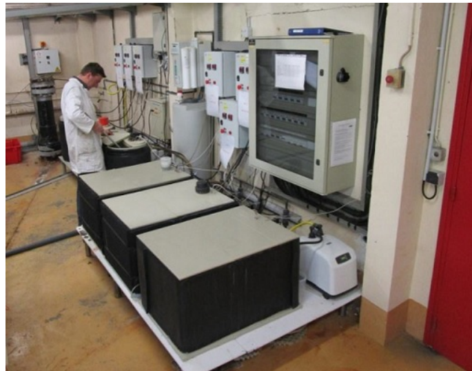
FIGURE II.19 – Bacs de vieillissement en immersion
