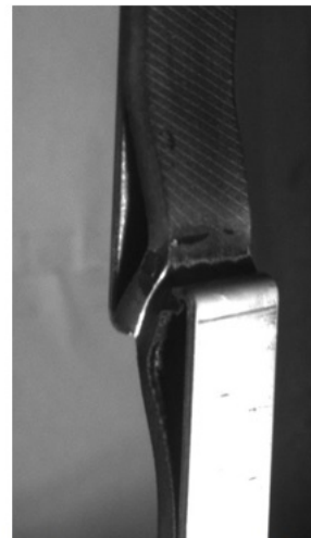
(b) Déformée avec rigidification du revêtement
