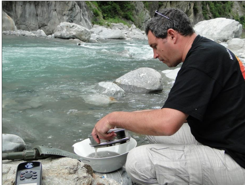
Figure 4.3 : Echantillonnage des sédiments fluviaux. Les sédiments sont tamisés (à 125 \mu\text{m} ) dans une coupelle pour en extraire les particules les plus fines.
