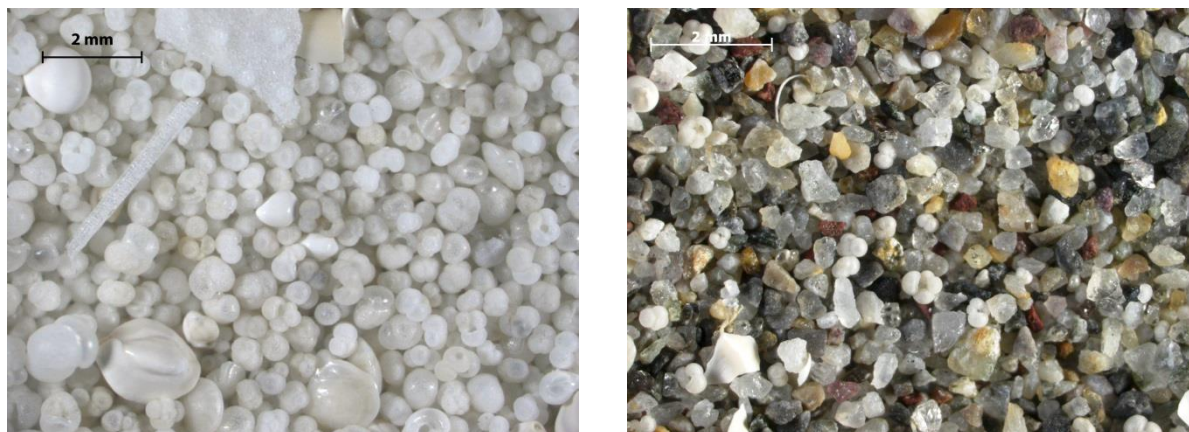
Figure 5.1 : Contenu de la fraction sableuse (refus de tamis à 125 \mu\text{m} ). Dans les faciès hémipélagiques (à gauche), cette fraction est composée de particules biogènes, essentiellement des foraminifères planctoniques. Dans les faciès turbiditiques (à droite), la fraction sableuse est composée de sables détritiques et de particules biogènes allochtones.
