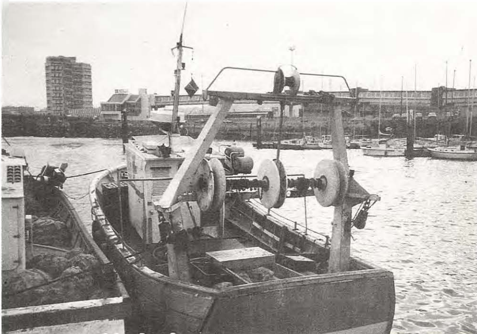
Figure 15 : Navires trémailleurs du port de Boulogne-sur-mer : -a . anciennes vedettes de plaisance -b . navire polyvalent
