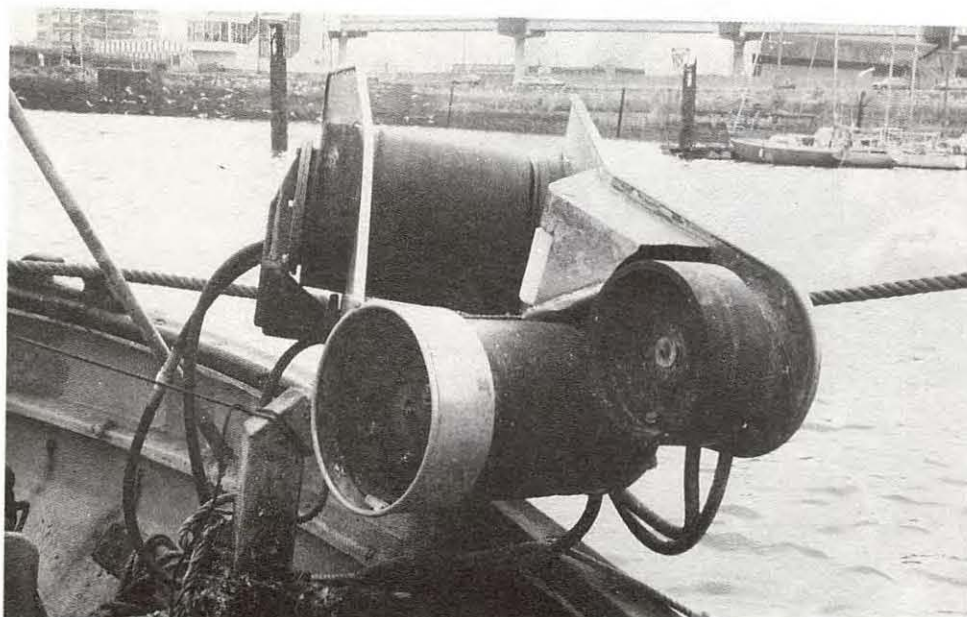
Figure 18 : Vire-filets utilisés sur les navires trémailleurs de Boulogne-sur mer : -a . vire-filet autonome à flasque : -b . vire-filet autonome à rouleaux.
