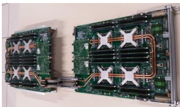
Figure 7-1: lame contenant 4 nœuds de calcul, refroidissement liquide des CPU
