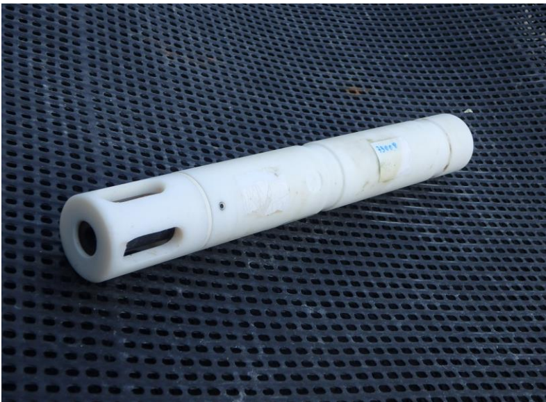
Figure 4 : Sonde d'enregistrement STPS. Crédit photo : J. Normand, Ifremer.
