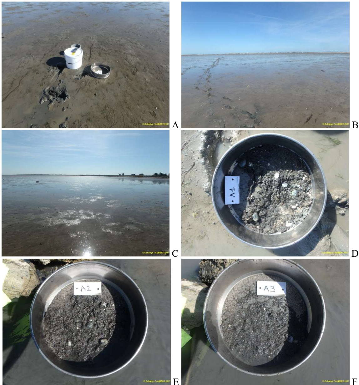
Figure 5 : Matériel et position des prélèvements au carottier sur chacune des 3 sous-stations (passages A, B et C) et illustration de 3 réplicats de prélèvement faunistique sur la sous-station ou passage A avec A-1, A-2 et A-3 (D, E, F). Exemple à la station « Plage de La Charge neuve » de la masse d'eau FRGC53 Pertuis Breton.
