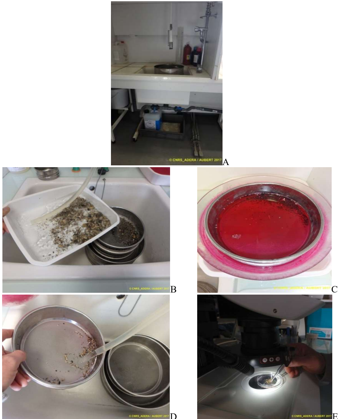
Figure 14 : Opération de rinçage des eaux de fixation puis de lavage à grande eau (A), tri hydraulique (B), coloration des refus de tamis (C) et rinçage (D) puis de tri à la loupe binoculaire des éléments les plus fins.
