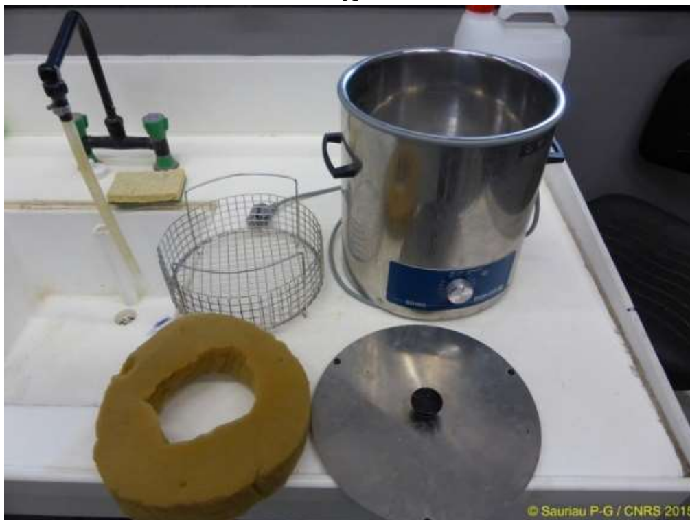
Figure 12 : Bain à ultrasons (A) avec détails du porte tamis et de la collerette en mousse (B) pour maintenir un bol à sédiment.
