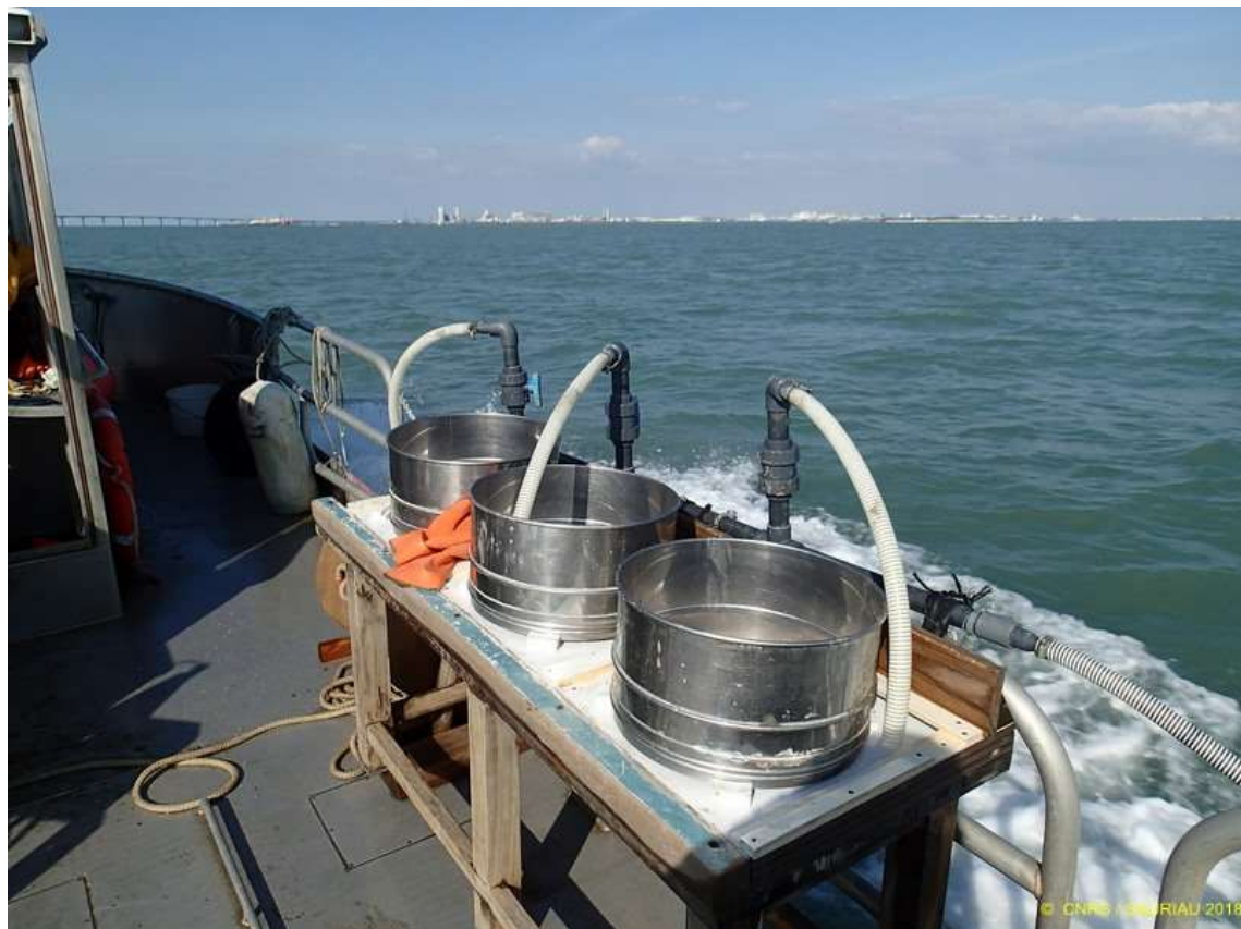
Figure 6 : Navire L'ESTRAN de l'Université de La Rochelle utilisé pour l'échantillonnage DCE (A) et vue de la table de tamisage à bord, tamis maille carrée 1 mm (B).
