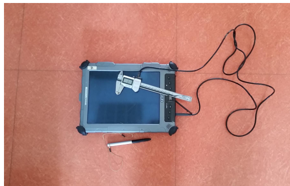
Figure 3 : Pied à coulisse relié directement à l'ordinateur
