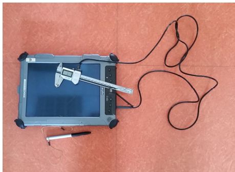
Figure 2 : Pied à coulisse relié directement à l'ordinateur
