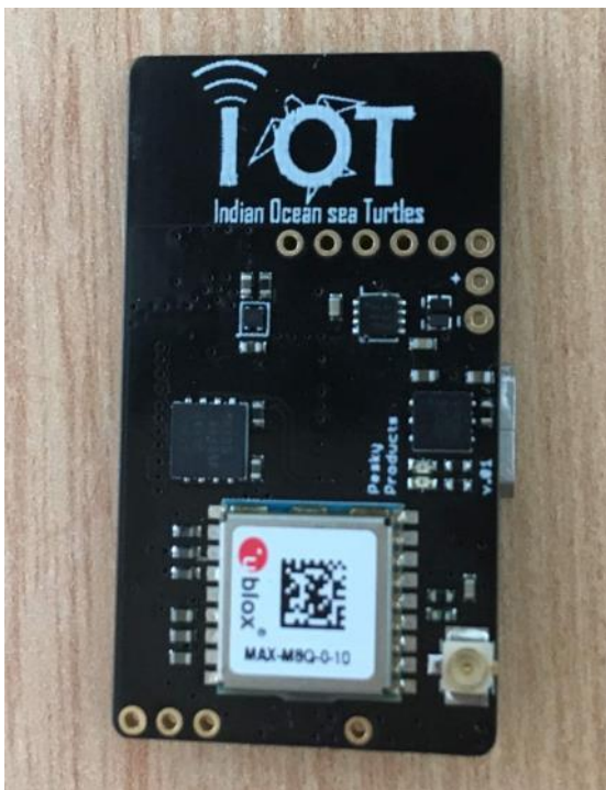
Carte électronique développée pour le projet et la version 2 de la balise © IFREMER
