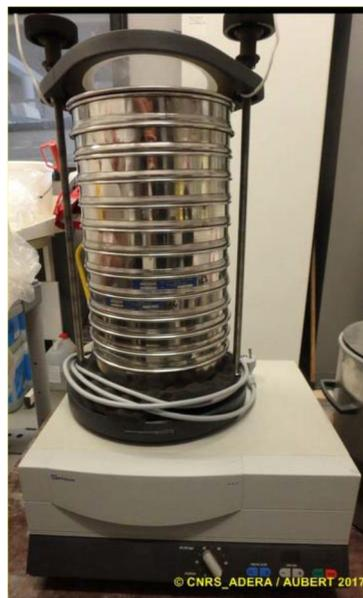
Figure15 : Colonne de tamis normalisée AFNOR sur tamiseuse Retsch
