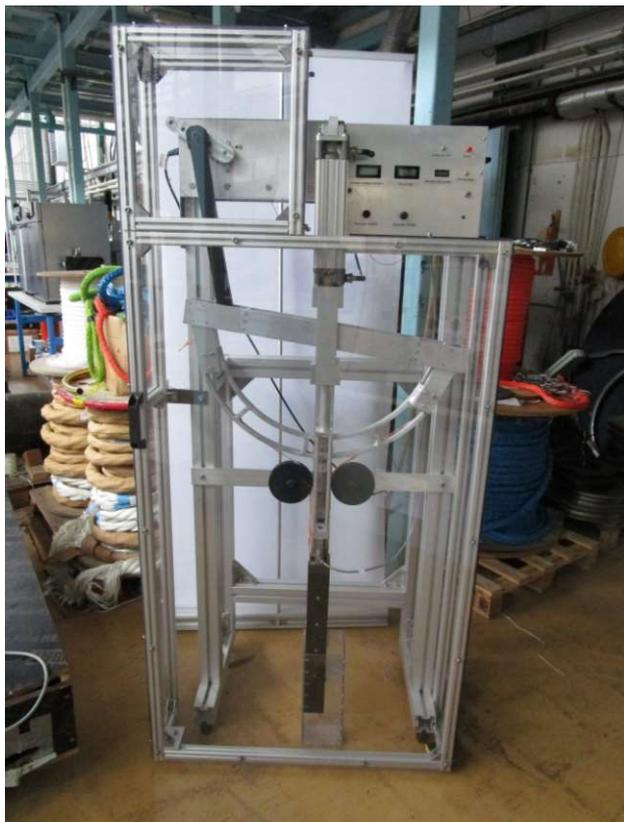
*Machine d'essai de cordages sur réa*
