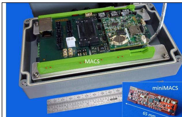
Modules électroniques pour l'acquisition des mesures (MACS, en version « labo », pour l'acquisition Standard et miniMACS, pour la phase de planté de la tige).
