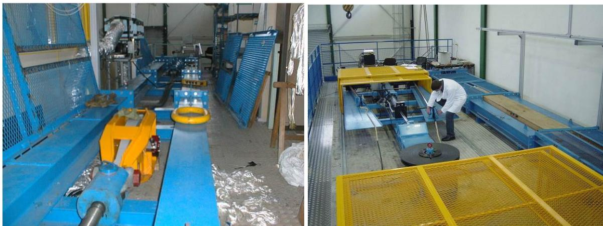
L'Ifremer dispose de bancs de traction classiques électromécaniques (capacité 10 à 200 kN) depuis plus de 20 ans. Combinés avec des bacs de vieillissement dans l'eau de mer et l'eau dé-ionisée, ces machines ont permis de nombreuses études de la corrélation entre vieillissement et modification du comportement mécanique de polymères et composites.
