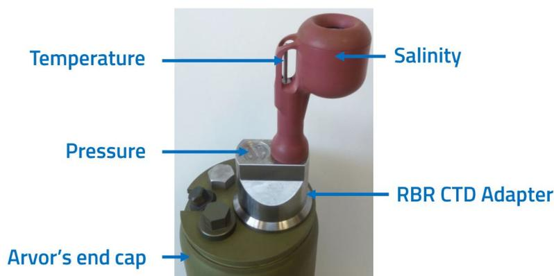
*Capteur CTD (Conductivity, Temperature, Depth) RBR monté sur la tête de l'Arvor, pour qualification de la pièce d'adaptation en caisson hyperbare.*
