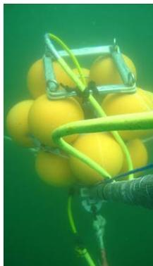
*Eléments de flottabilité du joint tournant mis en œuvre pour le flotteur EOLINK 10 ancré sur le site de Sainte Anne du Portzic.
