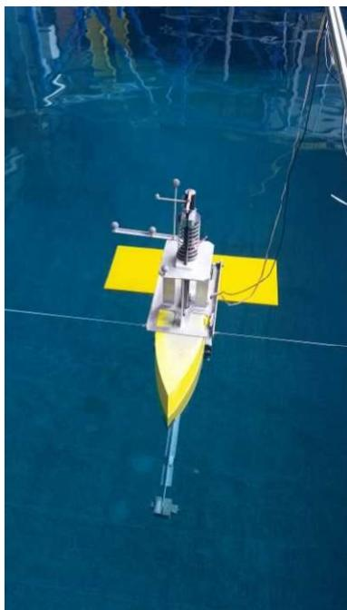
*Maquette du concept Bluefins équipé d'un moteur de contrôle de pilonnement*
