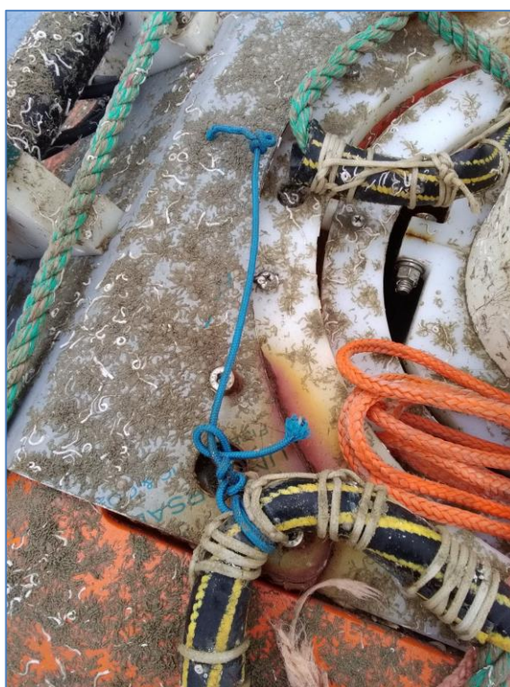
Figure 4 - Rupture de la ligne de thermistances
