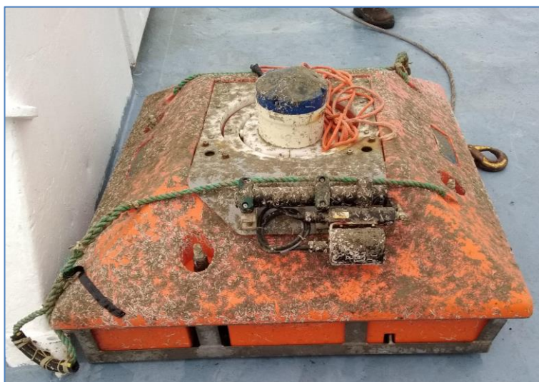
Figure 3 - Remontée du flotteur sans le lest
