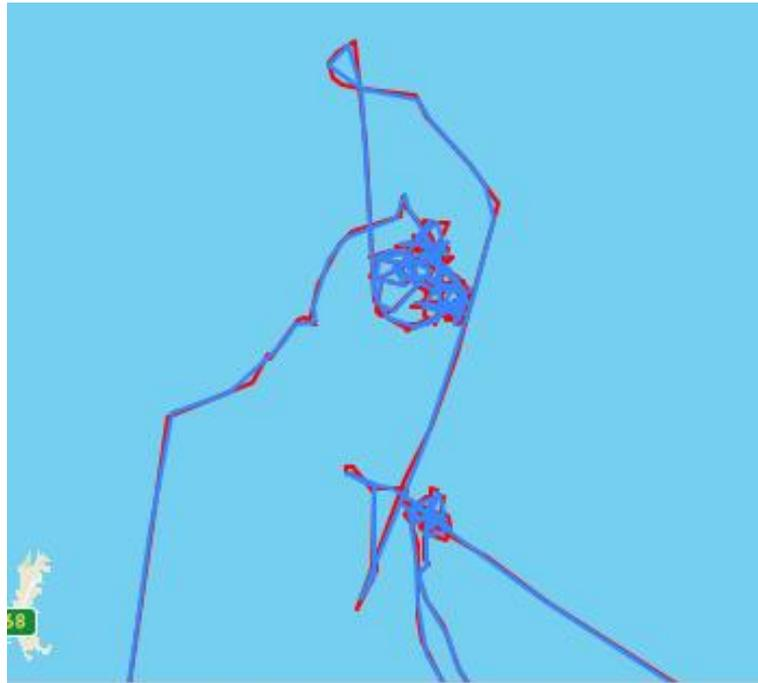
*Figure 1 : Cartographie comparée des trajectoires d'un chalutier hauturier selon la VMS (en bleu, fréquence d'acquisition de 1 heure) et selon RECOPECA (en rouge, fréquence d'acquisition de 15').*
