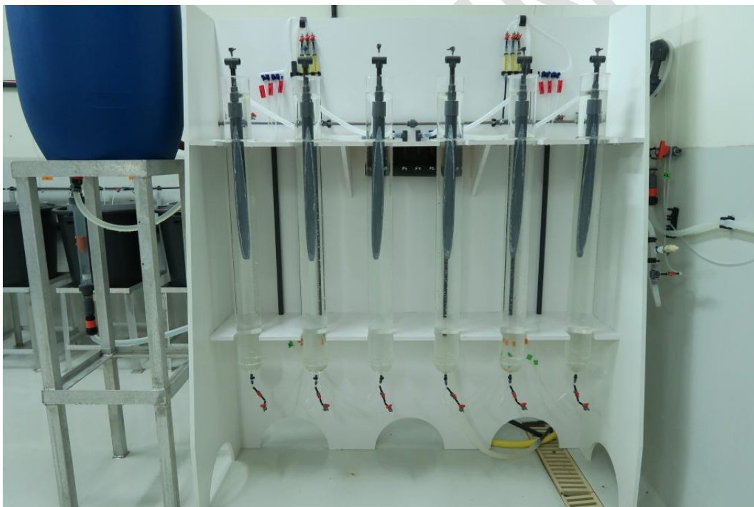
Figure 12. Les modules d'élevage larvaire de P. margaritifera en circuit ouvert. (A) les deux systèmes en place. (B) le système en « flûte ».
