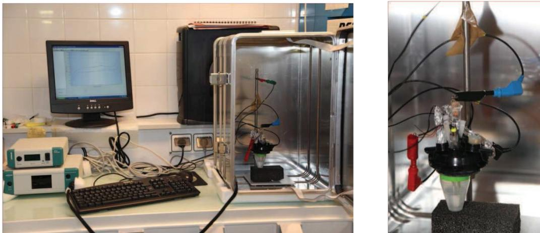
Figure III-2. Photographie du dispositif utilisé pour l'isolation de la cellule d'électrolyse. (© Alain Le Mercier / IUEM)
