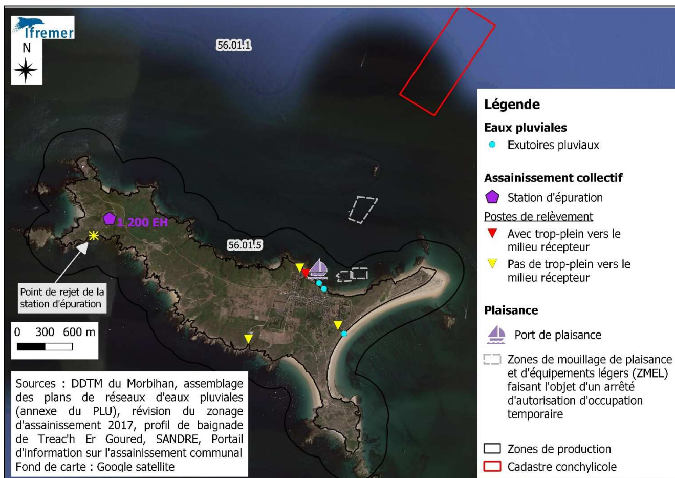
Figure 23 : principales sources potentielles de contamination microbiologique de la concession de moules au nord de l'île de Houat
