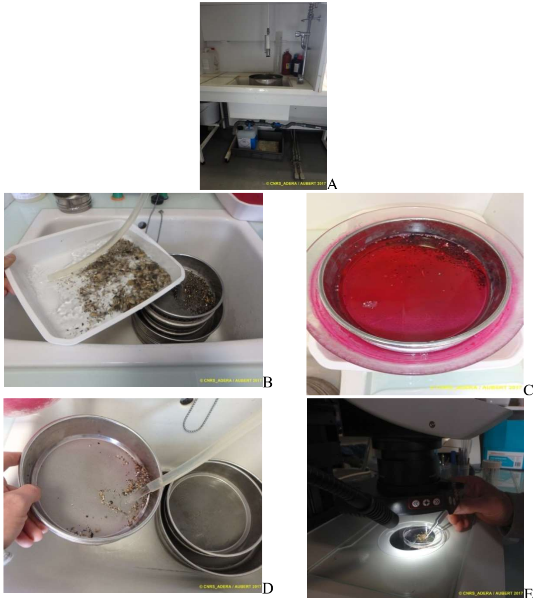
Figure 13 : Opération de rinçage des eaux de fixation puis de lavage à grande eau sous Sorbonne (A), tri hydraulique (B), coloration des refus de tamis (C) et rinçage (D) puis de tri à la loupe binoculaire des éléments les plus fins.
