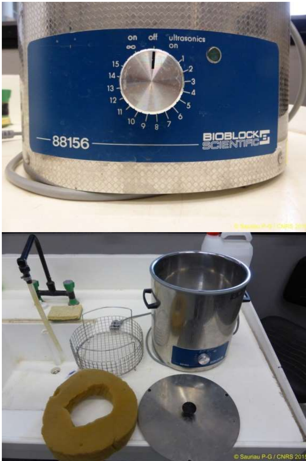
Figure 12 : Bain à ultrasons (A) avec détails du porte tamis et de la collerette en mousse (B) pour maintenir un bol à sédiment.
