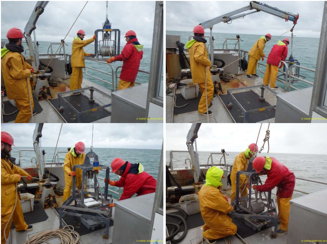
Figure 4 : Déroulement des opérations lors d'un prélèvement à la benne Smith.
