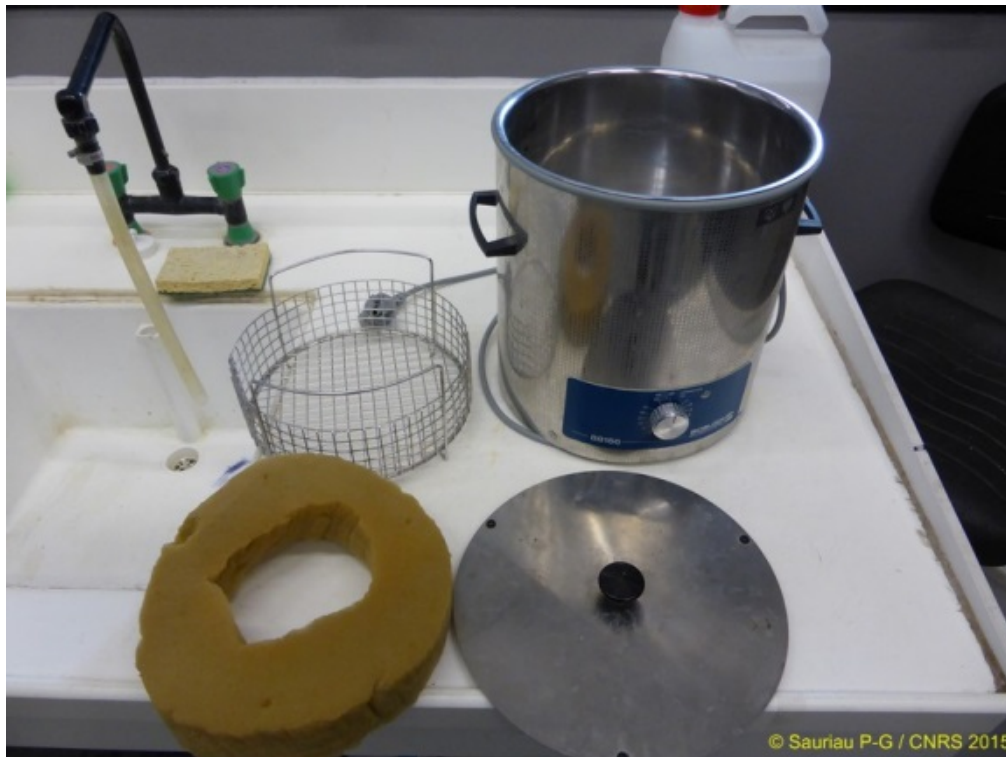
Figure 11 : Bain à ultrasons (A) avec détails du porte tamis et de la collerette en mousse (B) pour maintenir un bol à sédiment.
