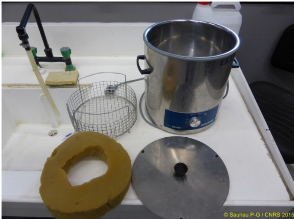
Figure 11 : Bain à ultrasons (A) avec détails du porte tamis et de la collerette en mousse (B) pour maintenir un bol à sédiment. Photo P.-G. Sauriau CNRS ©.
