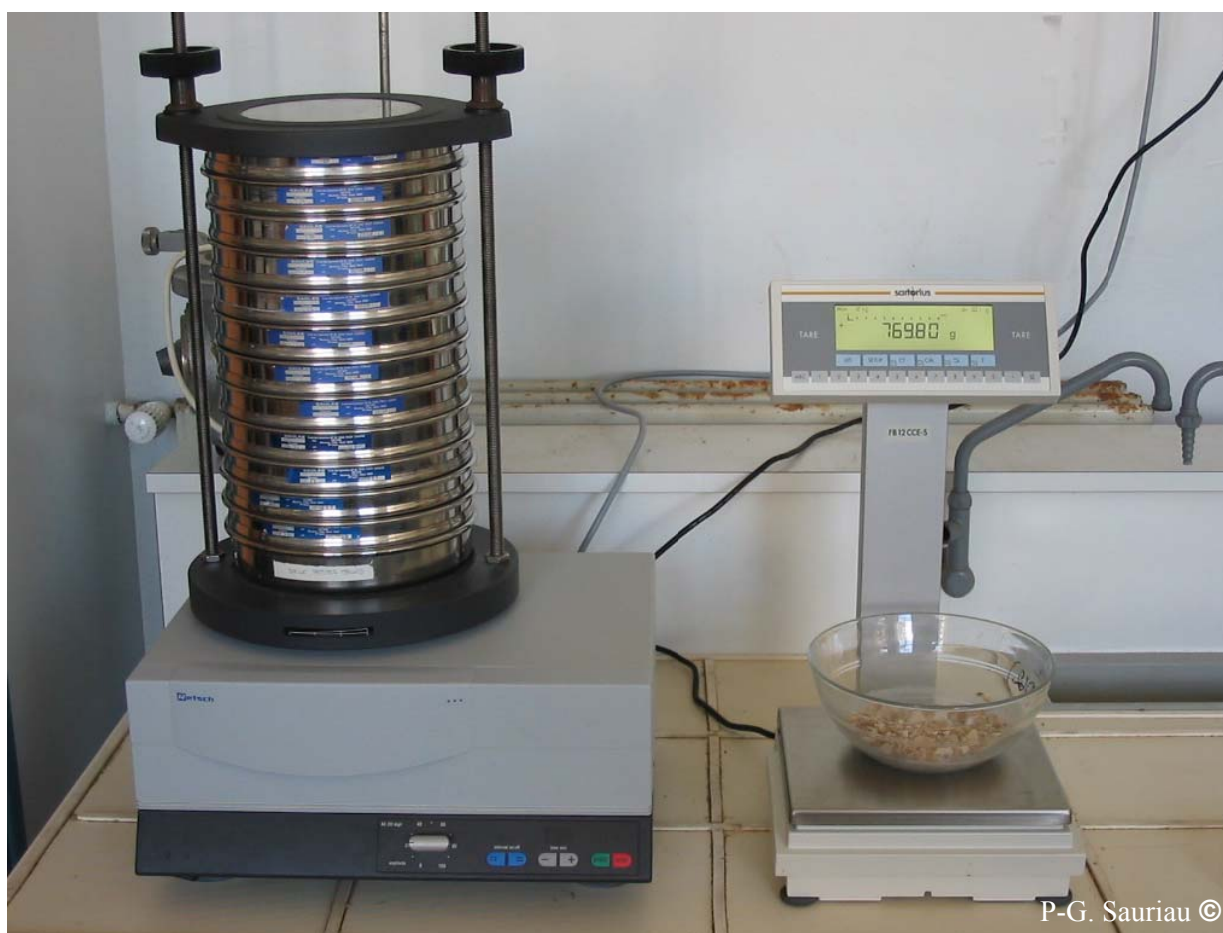
Figure 10 : Colonne de tamis normalisés AFNOR sur tamiseuse Retsch et balance Sartorius à 0,01 g. Photo P.-G. Sauriau CNRS ©.
