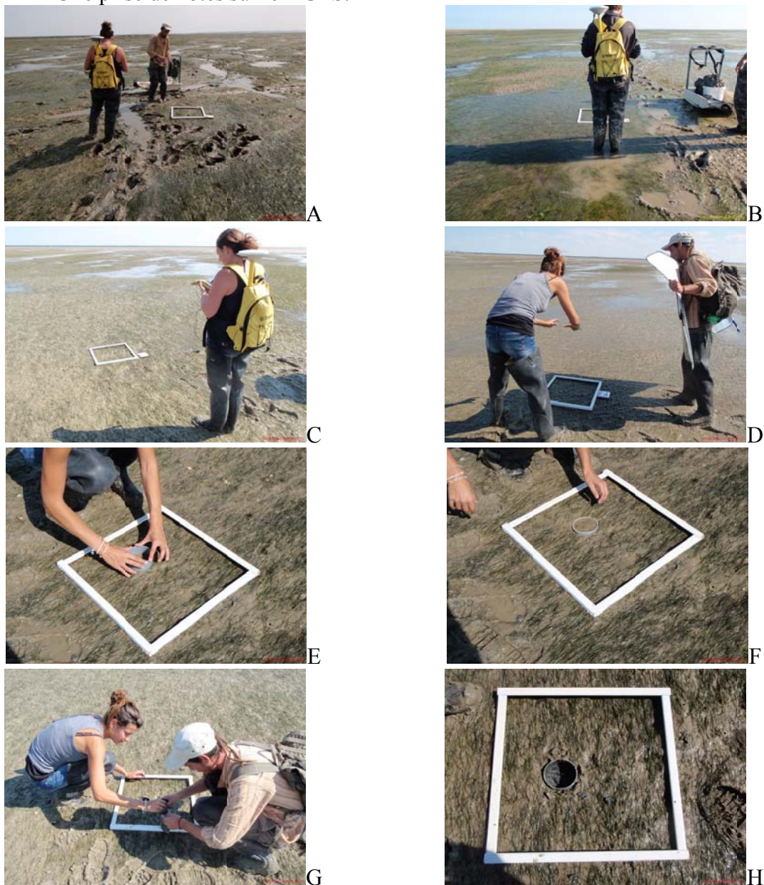
Figure 3 : Illustrations du positionnement par DGPS Trimble GeoXT (A, B et C), de la prise photo d'un quadrat avec utilisation d'un pare-soleil (D) et des prélèvements granulométriques (E à H) comme réalisé en 2012. Photos P. Cajeri et C. Curti, CNRS ©.
