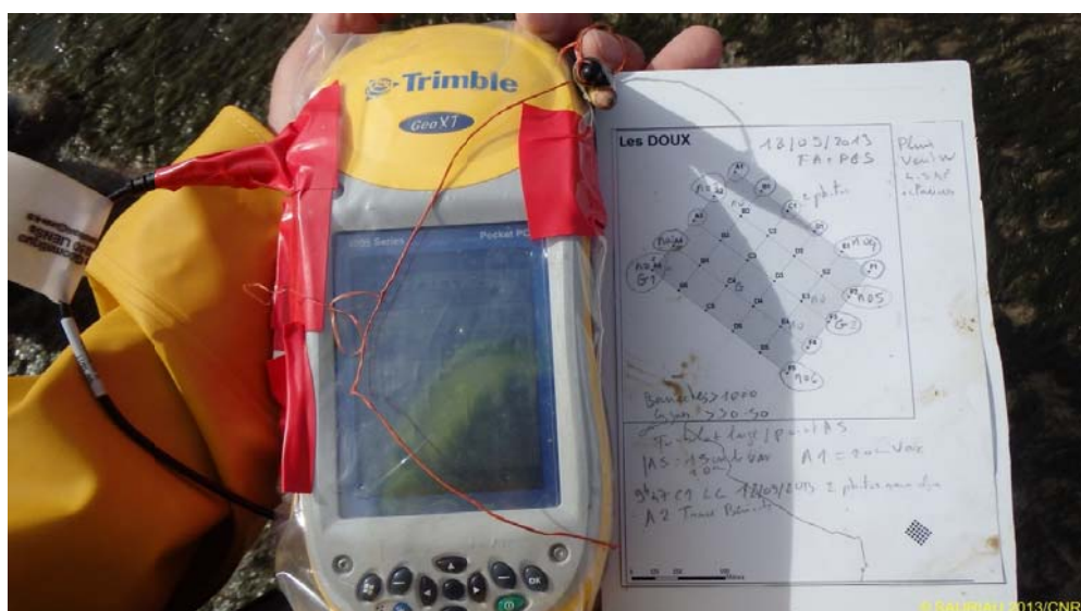
Figure 5 : Prise de notes associant table attributaire du DGPS et feuille terrain, exemple pour la station les Doux 2013 de la masse d'eau côtière « Pertuis Charentais ». Photo 18/09/2013 P.-G. Sauriau CNRS ©.
