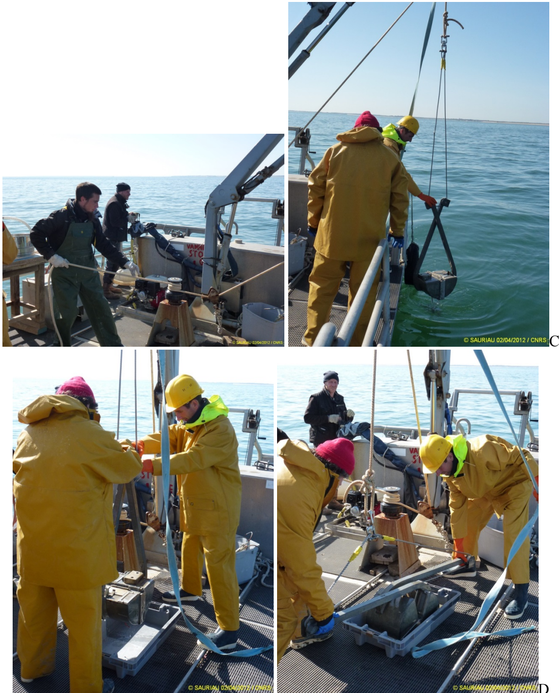
Figure 4 : Déroulement des opérations lors d'un prélèvement à la benne Van Veen.
