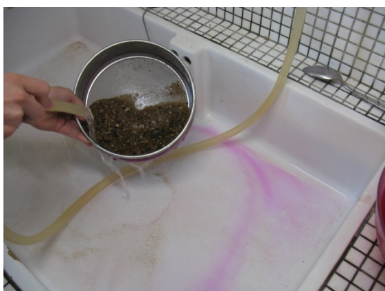
Figure 10 : Opération de rinçage des eaux de fixation puis de lavage à grande eau (A), tri hydraulique (B), coloration des refus de tamis (C) et rinçage (D) puis de tri à la loupe binoculaire des éléments les plus fins. Photos M. Chenoun, M. Sauriau & P. Cajeri CNRS ©.
