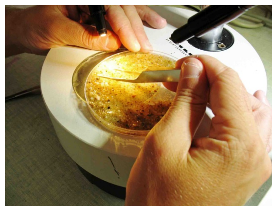
Figure 10 : Opération de rinçage des eaux de fixation puis de lavage à grande eau (A), tri hydraulique (B), coloration des refus de tamis (C) et rinçage (D) puis de tri à la loupe binoculaire des éléments les plus fins. Photos M. Chenoun, M. Sauriau & P. Cajeri CNRS ©.
