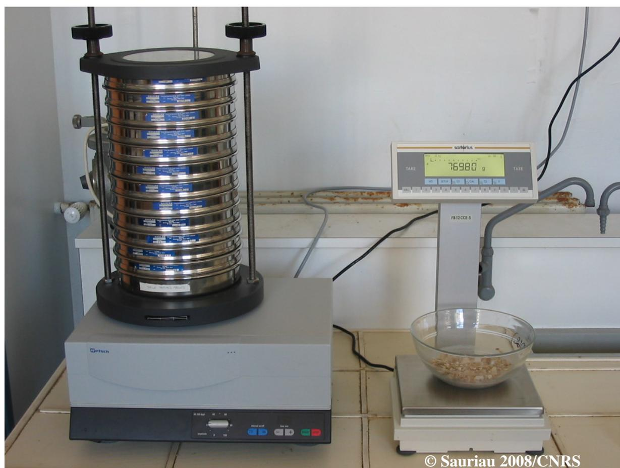
**Figure 15** : Colonne de tamis normalisés AFNOR sur tamiseuse Retsch et balance Sartorius à 0,01 g. Photo P.-G. Sauriau CNRS ©.
