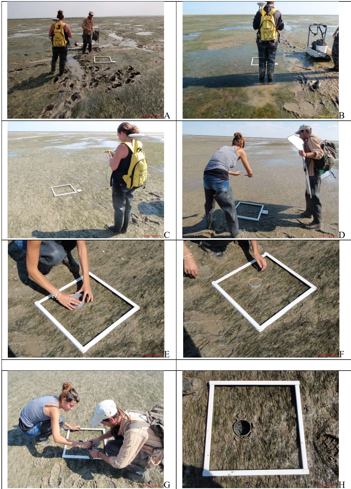
Figure 6 : Illustrations du positionnement par DGPS Trimble GeoXT (A, B et C), de la prise de photo d'un cadrat avec utilisation d'un pare-soleil (D) et des prélèvements granulométriques (E à H). Clichés de 2012 Cajeri & Curti
