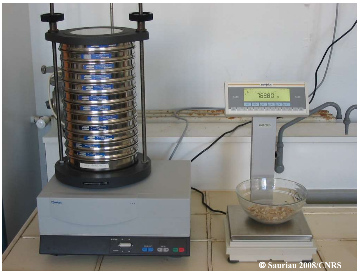
Figure 7 : Colonne de tamis normalisés AFNOR sur tamiseuse Retsch et balance Sartorius à 0,01 g.
