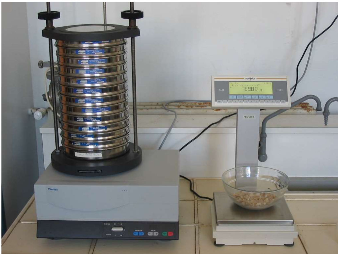
Figure 9 : Colonne de tamis normalisés AFNOR sur tamiseuse Retsch et balance Sartorius à 0,01 g. Photo © CNRS / Sauriau P.-G. 2008.
