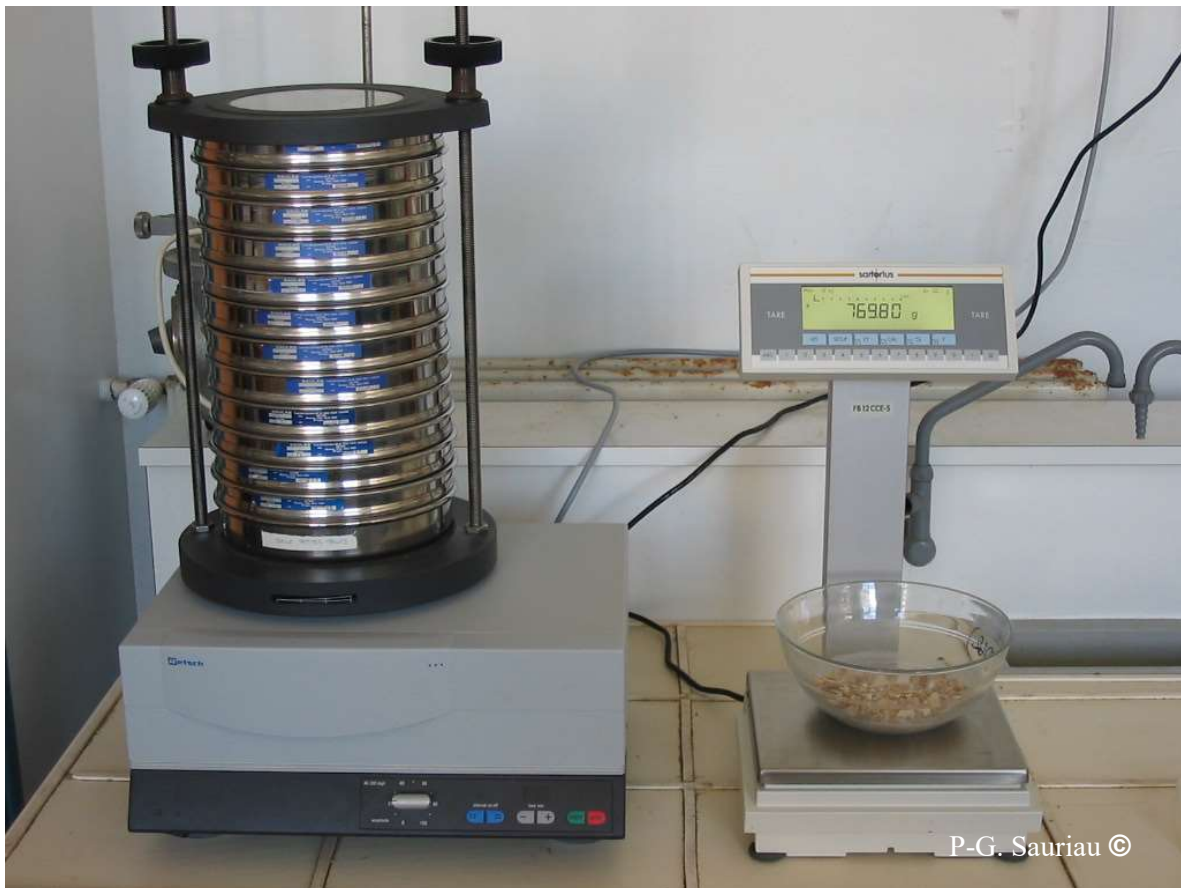
Figure 8 : Colonne de tamis normalisés AFNOR sur tamiseuse Retsch et balance Sartorius à 0,01 g. Photo P.-G. Sauriau CNRS ©.
