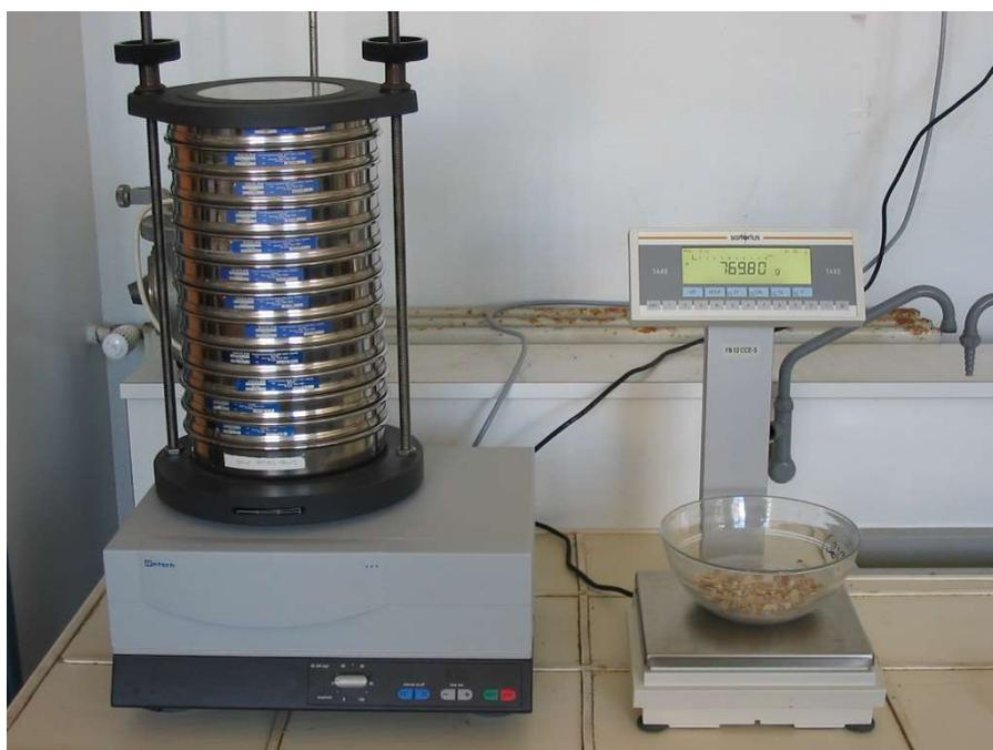
**Figure 6** : Colonne de tamis normalisés AFNOR sur tamiseuse Retsch et balance Sartorius à 0,01 g. Photo © CNRS / Sauriau P.-G. 2008.
