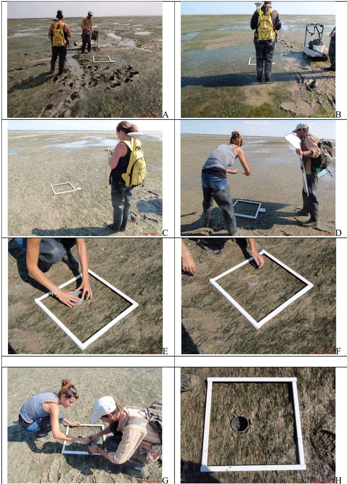
Figure 6 : Illustrations du positionnement par DGPS Trimble GeoXT (A, B et C), de la prise de photo d'un cadrat avec utilisation d'un pare-soleil (D) et des prélèvements granulométriques (E à H).
