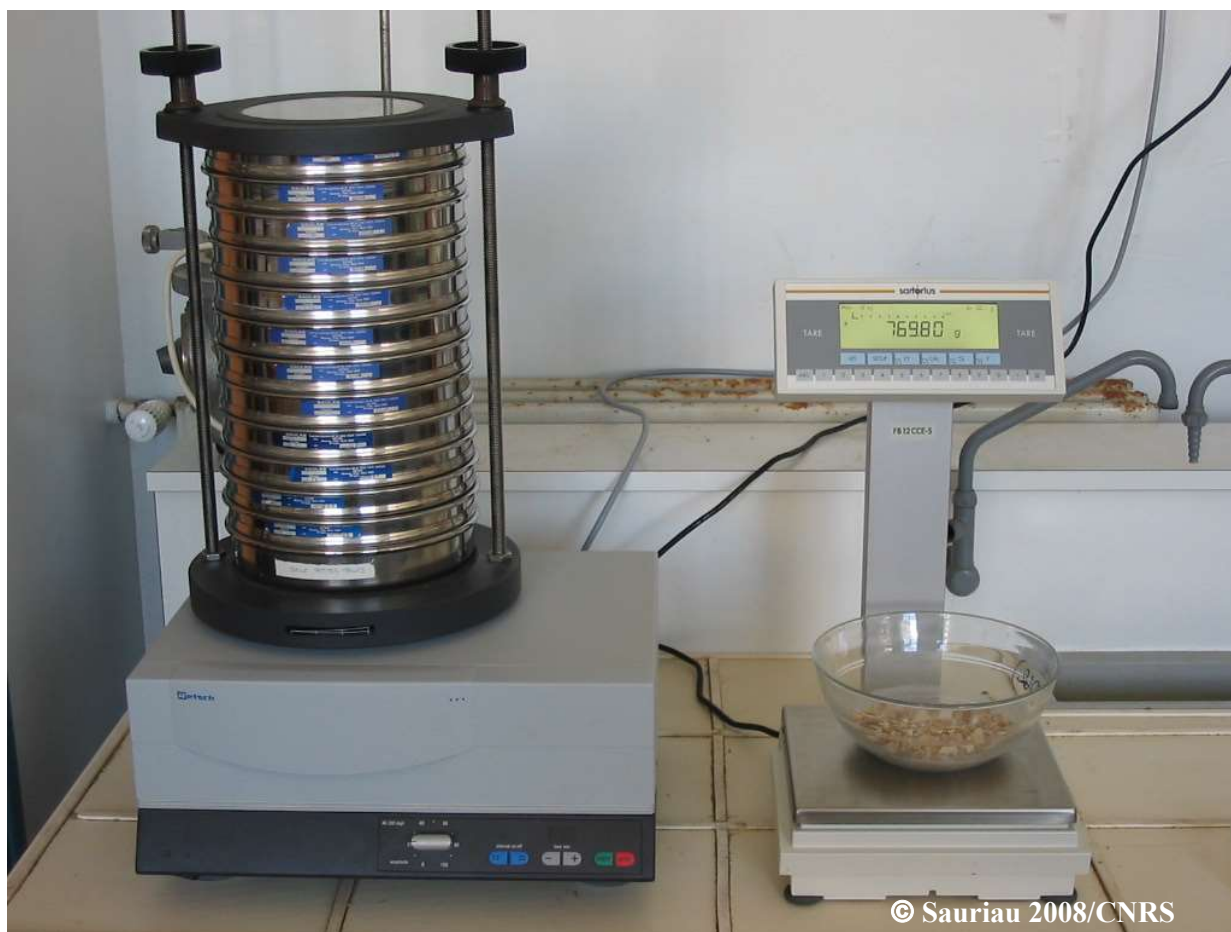
Figure 9 : Colonne de tamis normalisés AFNOR sur tamiseuse Retsch et balance Sartorius à 0,01 g.
