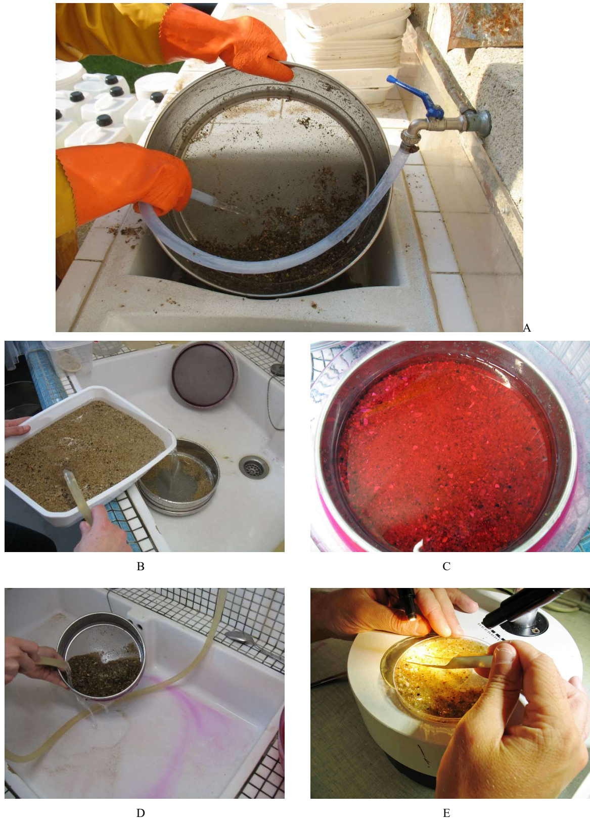
Figure 11 : Opération de rinçage des eaux de fixation puis de lavage à grande eau (A), tri hydraulique (B), coloration des refus de tamis (C) et rinçage (D) puis de tri à la loupe binoculaire des éléments les plus fins. Photos M. Chenoun, M. Sauriau & P. Cajeri CNRS ©.
