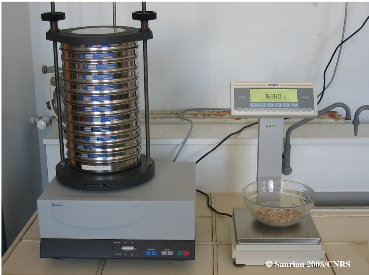
**Figure 10** : Colonne de tamis normalisés AFNOR sur tamiseuse Retsch AS 200 digit et balance Sartorius à 0,01 g.
